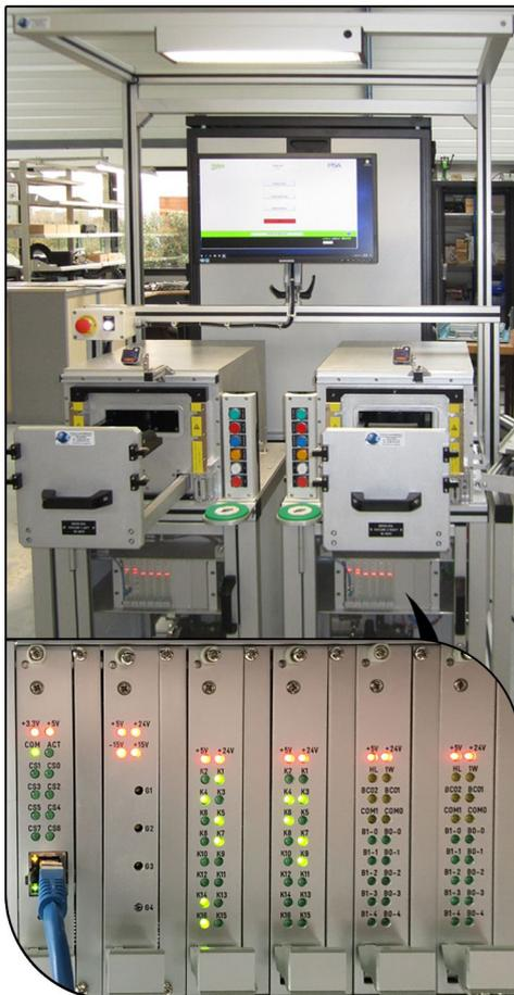
Fort de son expérience passée sur le test de calculateurs dédiés à l'accès et au démarrage Mains libres des véhicules, DBA a été choisi par un équipementier automobile pour réaliser le banc de test de production d'un calculateur qui intègre également des fonctionnalités Bluetooth, afin d'autoriser l'accès et le démarrage du véhicule à l'aide de son Smartphone.
