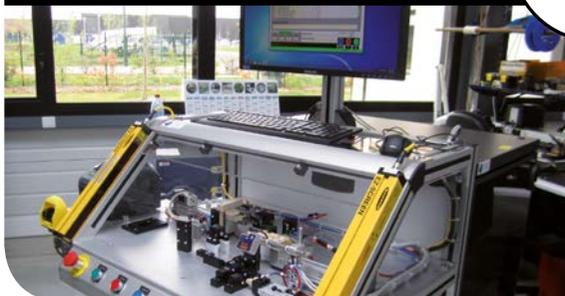
TESTEUR FONCTIONNEL POUR CAPTEUR
